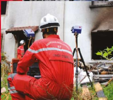
Si el movimiento de la estructura sobrepasa el umbral elegido por parametrización, se dispara una **potente alarma** para avisar del riesgo de caída de escombros de los edificios dañados por un terremoto, bombardeo, explosión de gas, incendio... o cualquier otra catástrofe.
