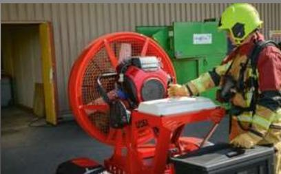
Estos ventiladores son soluciones móviles para la ventilación de grandes volúmenes o incluso de muy grandes volúmenes: Almacenes, túneles, aeropuertos, complejos industriales, edificios de gran altura, etc.
