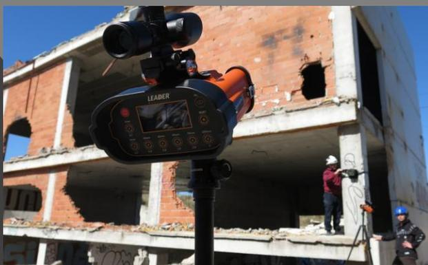
Leader SENTRY es un controlador de estabilidad que detecta los movimientos de estructura de un edificio inestable. Su láser permite supervisar de forma continua los movimientos detectados y presenta las variaciones para un seguimiento en tiempo real.
