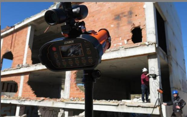
Leader SENTRY es un controlador de estabilidad que detecta los movimientos de estructura de un edificio inestable. Su láser permite supervisar de forma continua los movimientos detectados y presenta las variaciones para un seguimiento en tiempo real.
